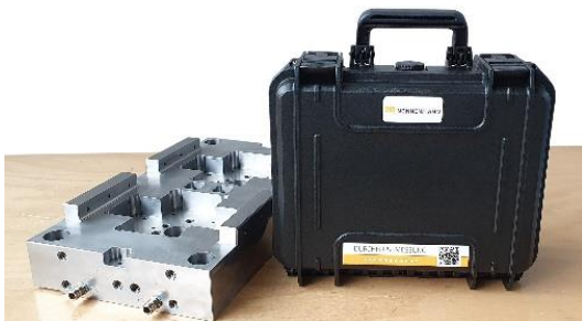
Set zur elektronischen Messung von Durchflussmenge und Temperatur des Temperiermediums
