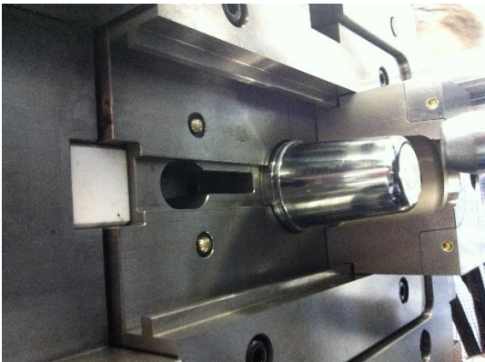
Formeinsatz AS mit Keramikelementen zentriert
